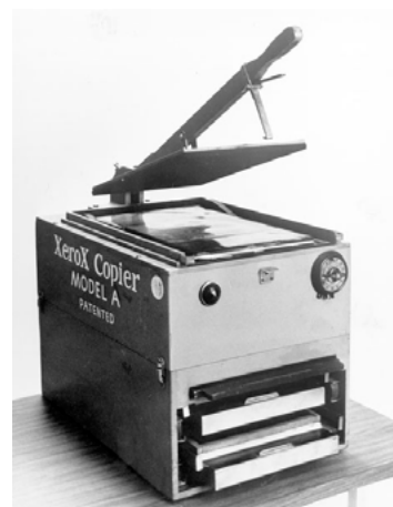
La stampa laser sfrutta gli stessi principi di riproduzione della fotocopia. Nella foto, la Xerox Model A del 1949
