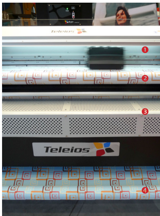
Stampa a sublimazione diretta con una d.gen Teleios. Il gruppo di stampa ❶ decora il tessuto ❷, che però risulta sbiadito fino al fissaggio nella calandra termica ❸. In pochi secondi l'inchiostro viene stabilizzato definitivamente, recuperando i colori desiderati ❹.
