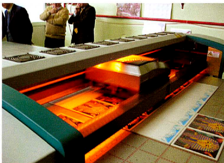
L'imponente carrello di stampa del T220 è caratterizzato dal bagliore crepuscolare della lampada di essiccazione
