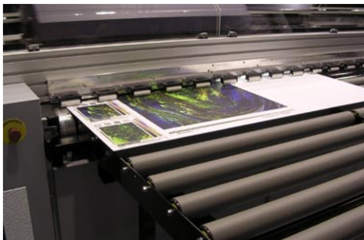
La regolazione della testina di stampa permette alla 205 di accettare pannelli fino a 40 millimetri di spessore. La diffusione dell'inchiostro è tale da consentire colori pieni ottima copertura anche su materiali irregolari, come legno, pietra o, in questo caso, il polistirolo Relief, gentilmente fornito da Caledonia
