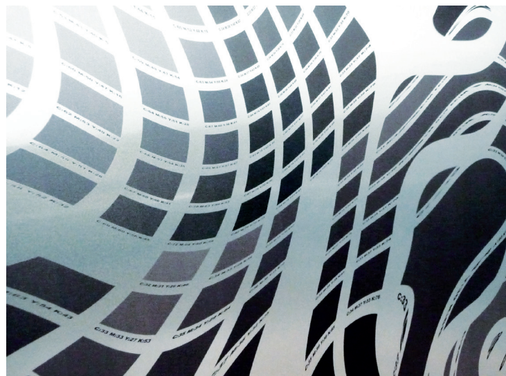
La levigatezza del materiale permette un'ottima tenuta del punto, con testi leggibili fino al corpo 2. Le immagini in toni di grigio composto ben si accoppiano al metallo, esaltate dal contrasto tra l'opacità dell'inchiostro e la riflettente dell'alluminio verniciato.
