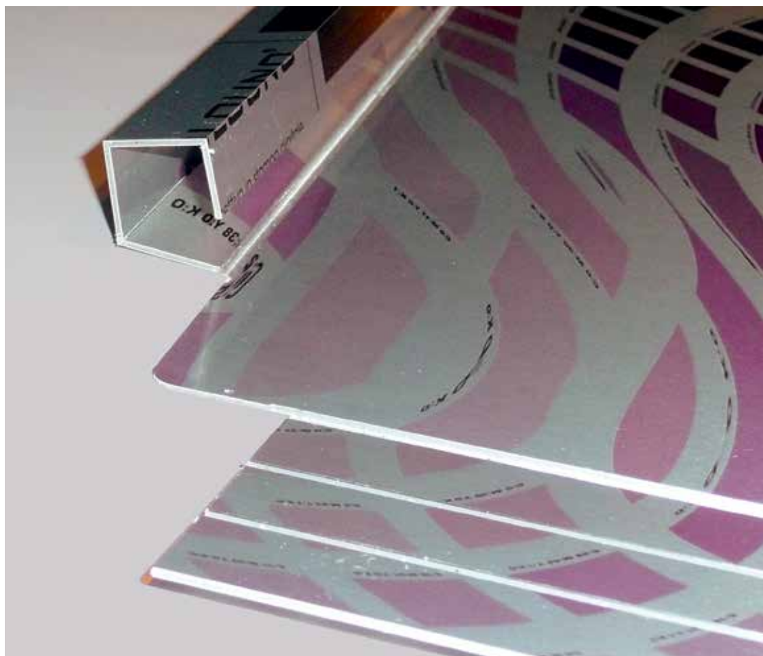
Diversi tipi di incisione su Hylite: taglio passante per il profilo, fresatura a V per pieghe a contatto e fresatura piatta per una piega più ampia.
