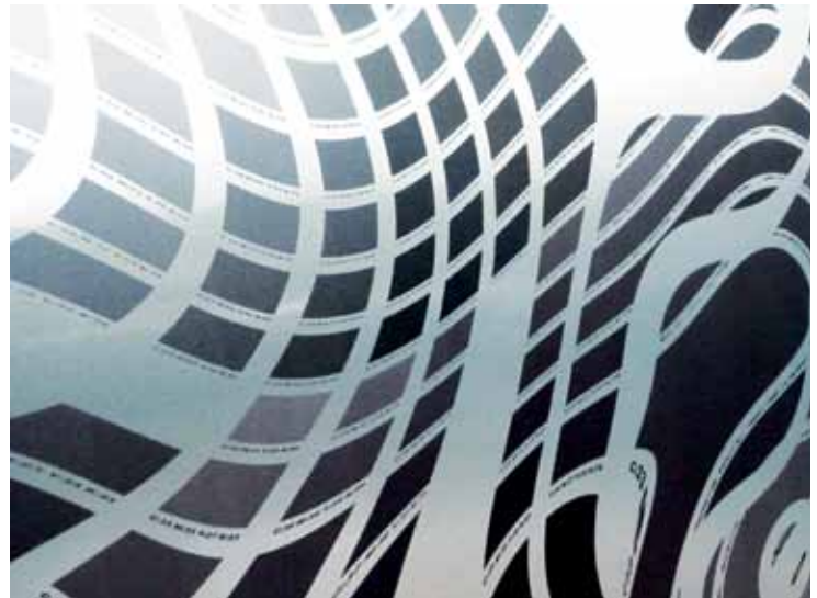
La levigatezza del materiale permette un'ottima tenuta del punto, con testi leggibili fino al corpo 2. Le immagini in toni di grigio composto ben si accoppiano al metallo, esaltate dal contrasto tra l'opacità dell'inchiostro e la riflettanza dell'alluminio verniciato.
