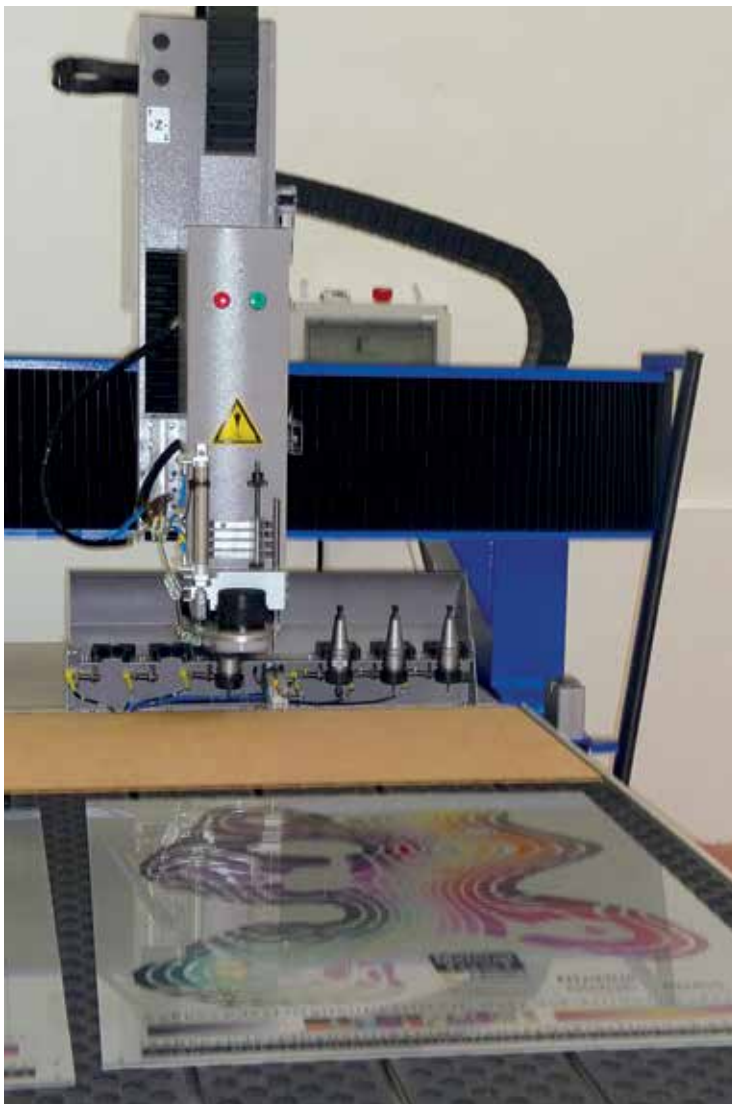
Fresatura piatta sui due lati. La rimozione dell'alluminio permette al poliuretano di piegarsi liberamente.
