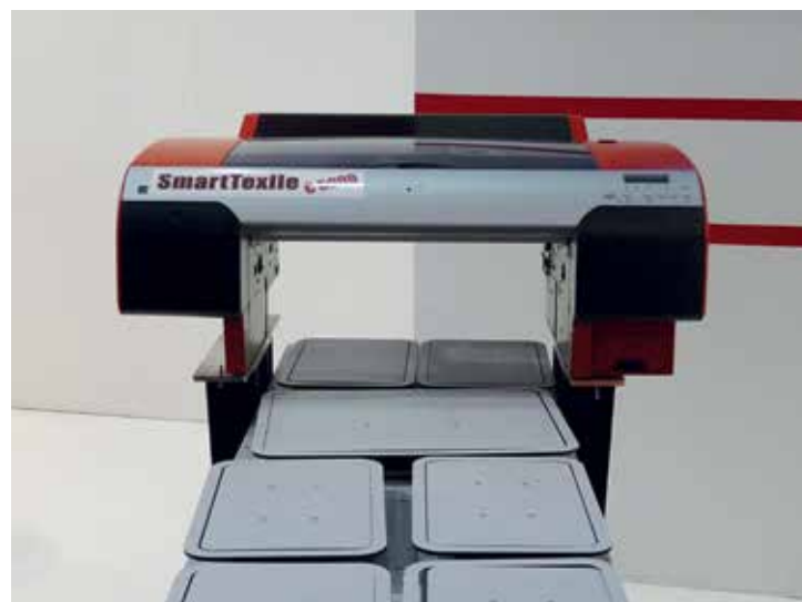
Il prototipo di stampante tessile derivata dalla Epson 4880 presentata al PTE da SmartColor
