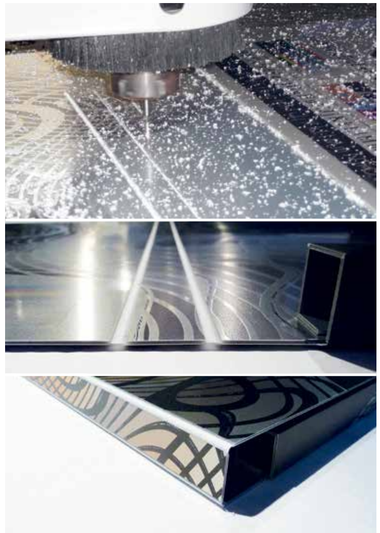
Fresatura piatta sui due lati. La rimozione dell'alluminio permette al poliuretano di piegarsi liberamente.
