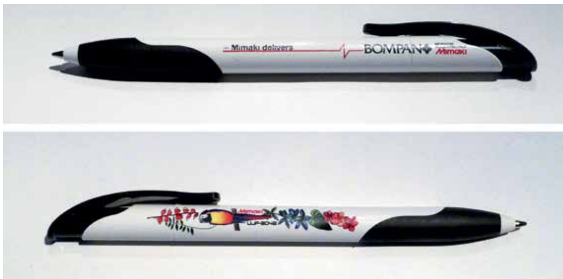
Questa penna realizzata con Mimaki UJF-3042 mostra due diverse tipologie di immagine. Da un lato una grafica netta, con logo e payoff stampati nettamente e rivestiti da un leggero strato trasparente. Sul fronte opposto un'immagine artistica, con colori saturi alternati a sfumature graduali. Nel primo caso le scritte sono più incisive ed emergono dall'oggetto, nel secondo l'immagine si fonde più morbidamente col supporto.
